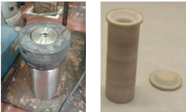
Figura 30. Autoclave y vaso de teflón empleados en un proceso de síntesis hidrotermal.
