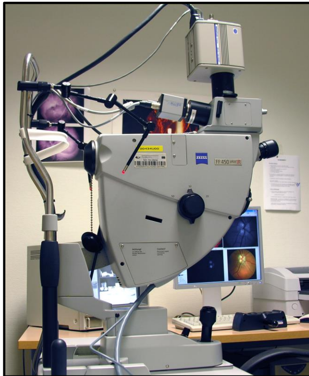
Figura 17. Cámara de fondo Zeiss FF 450+ IR plus, incluida videocámara de color 3CCD: AVT ZK-S, y cámara en blanco y negro Kodak Megaplug 1.
