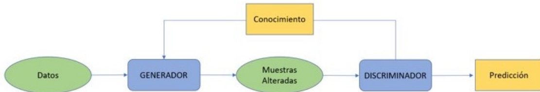
Figura 2.5: Estructura básica de una GAN.
