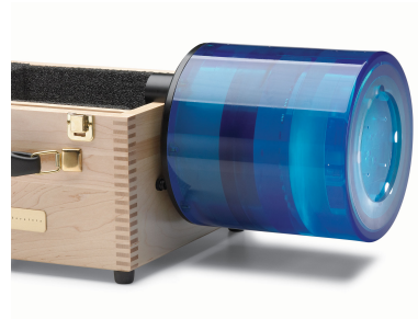
(d) Maniquí de calidad de imagen en TC y CBCT CATPHAN (The Phantom Laboratory).
