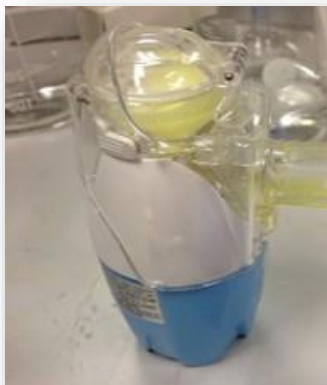
Figura 3: Dispositivo de nebulización que se conecta al NGI para los ensayos de determinación de MMAD y FPF a un flujo de aire de 25L/min.
