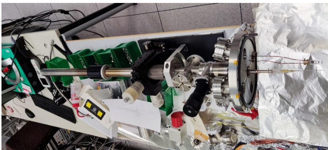
Figura 2.17. Detalle del sistema para la generación del haz molecular, el cual está formado por la molécula a estudio y argón (utilizado como gas de relleno). Imagen cortesía del Profesor Alexander Dorn (Instituto Max-Plank de Física nuclear, en Heidelberg).
