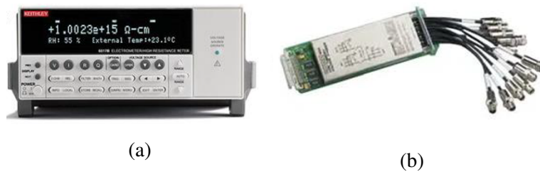
Figura 21: Imagen del electrómetro Keithley 6517B (a) y de la tarjeta de adquisición de datos Keithley 6522 (b) [47].
