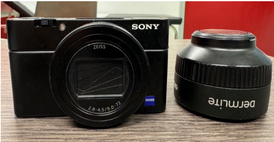
Figura 1. Cámara Sony RX100 VI, utilizada para la fotografía clínica y dermatoscópica en el presente trabajo. Dermatoscopio DermLite Foto X: lente de dermatoscopia universal que se conecta a cámara digital para la realización de las fotografías dermatoscópicas en el presente trabajo. Especificaciones técnicas: 24 LEDs polarizados, y 8 no polarizados, lente de 30 mm con un aumento de 8x .
