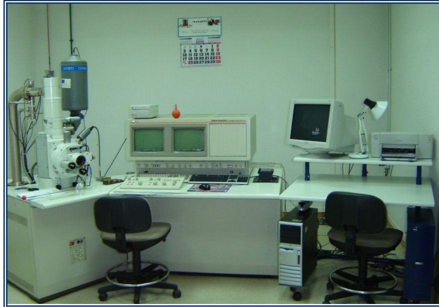
Fig. 18. Microscopio electrónico de barrido JSM-6400.
