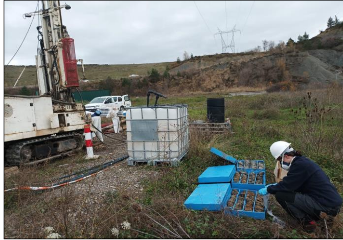
Figura 9. Testificación de sondeos en la parcela del pie del vertedero.
