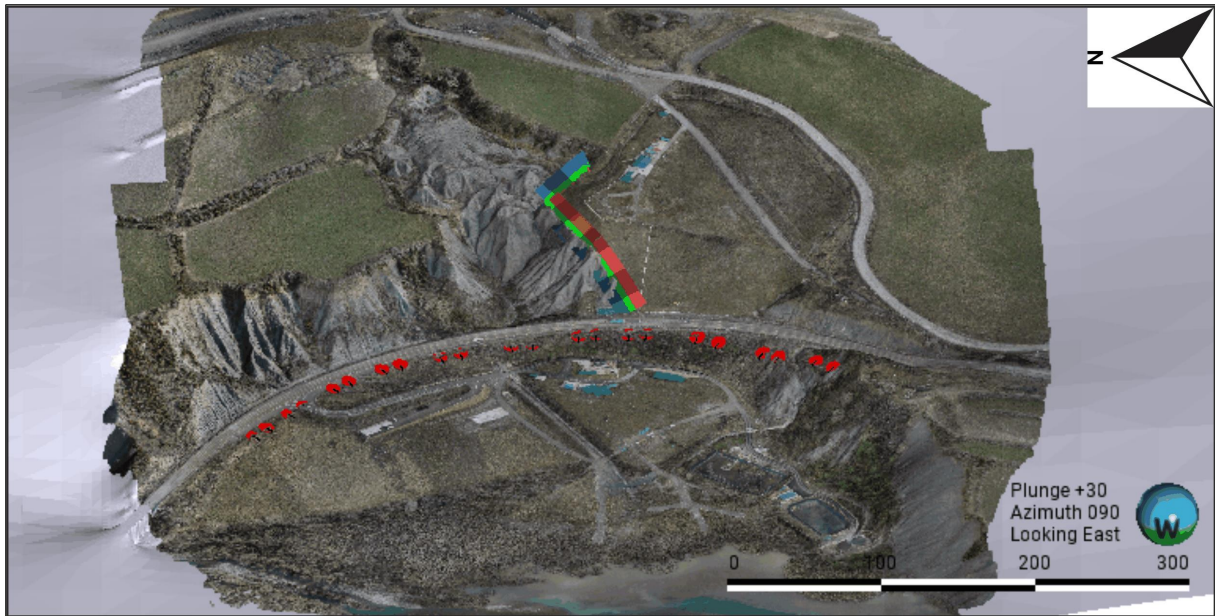
Figura 13. Los discos rojos constituyen la superficie estructural. La polilínea limita el vertedero en su contorno N. Ortofoto de 2025 cedida por [Emgrisa].
