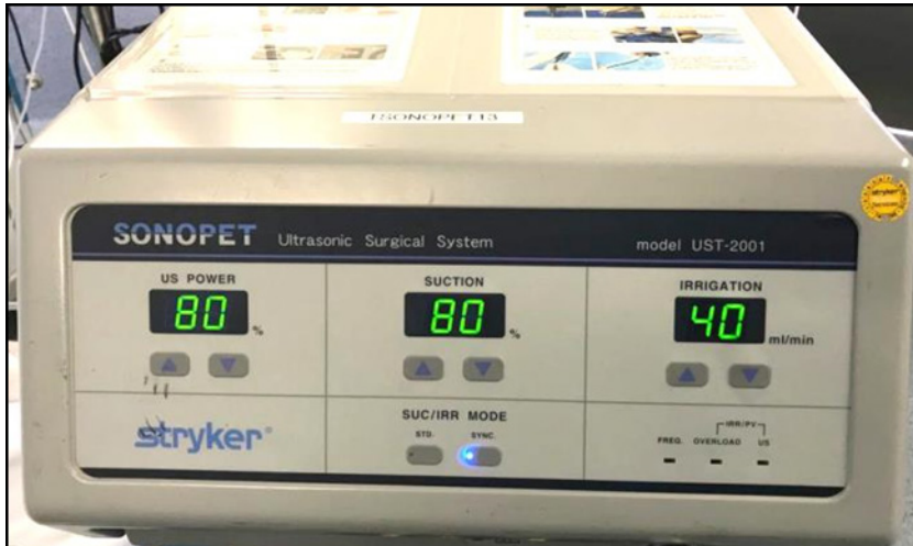
Figura 16. Consola. Mandos de control de potencia de ultrasonidos (%), aspiración (%) e irrigación (ml/min).
