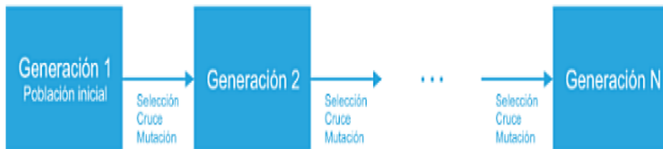
Figura 4: Esquema algoritmo genético [22]
