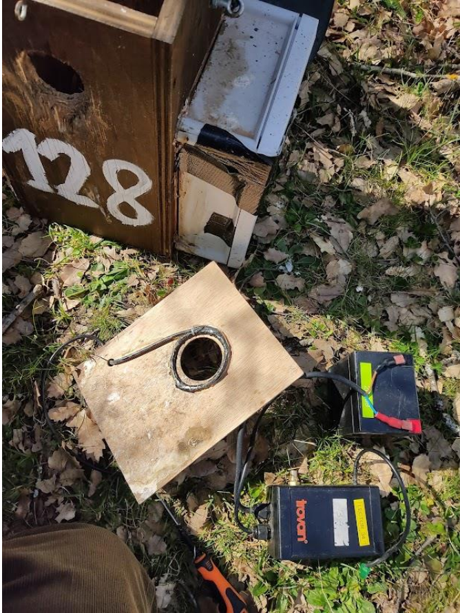
Figura 5: Sistema de lectura RFID formado por la antena de cobre acoplada a un doble frontal entrada del nido, el lector de Trovan © y una batería de 12 V.
