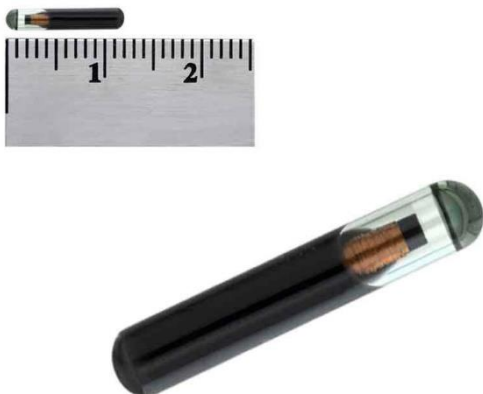
Figura 4: Transpondedor subcutáneo usado en esta Tesis.
