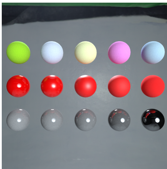
Figura 3.16: Comparación de los atributos albedo, roughness y metallic.
