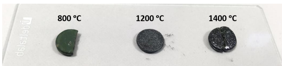
Figura 3.32. Evolución del color observado en las pastillas con el incremento de la temperatura de sinterizado.
