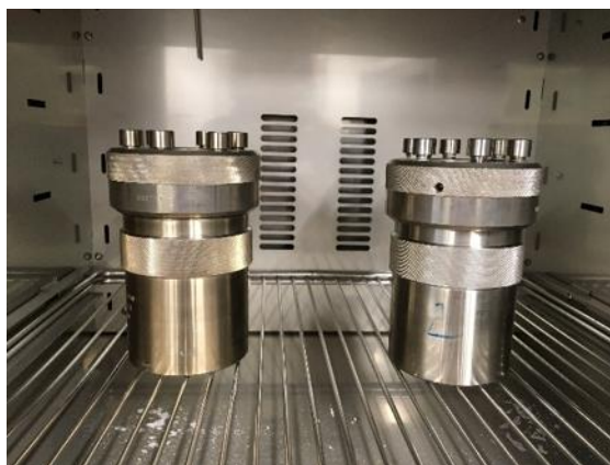
Figura 2.4. Autoclaves empleados en la síntesis hidrotermal.
