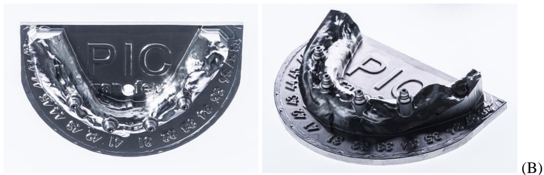
Figura 13. (A): Diseño del modelo; (B): Modelo mecanizado de titanio
