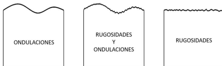
Figura 5. Componentes de una superficie según sus frecuencias: ondulación (izquierda), forma (centro) y rugosidad (derecha).
