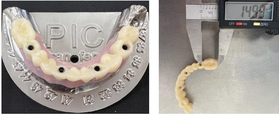
Figura 20. Prototipo de PMMA volumen total, comprobación del ajuste pasivo y longitud del CL
