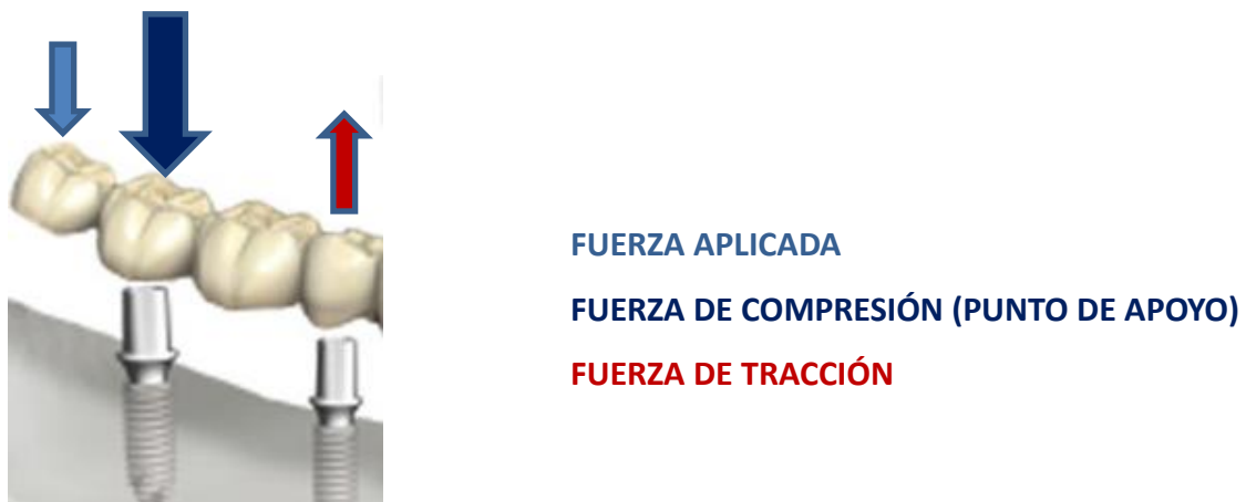
Figura 1. Representación esquemática de las fuerzas aplicadas sobre un cantiléver en implantoprótesis
