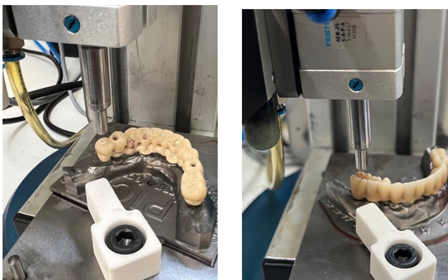
Figura 52. Aplicación de carga cíclica en ambos cantilévers.
