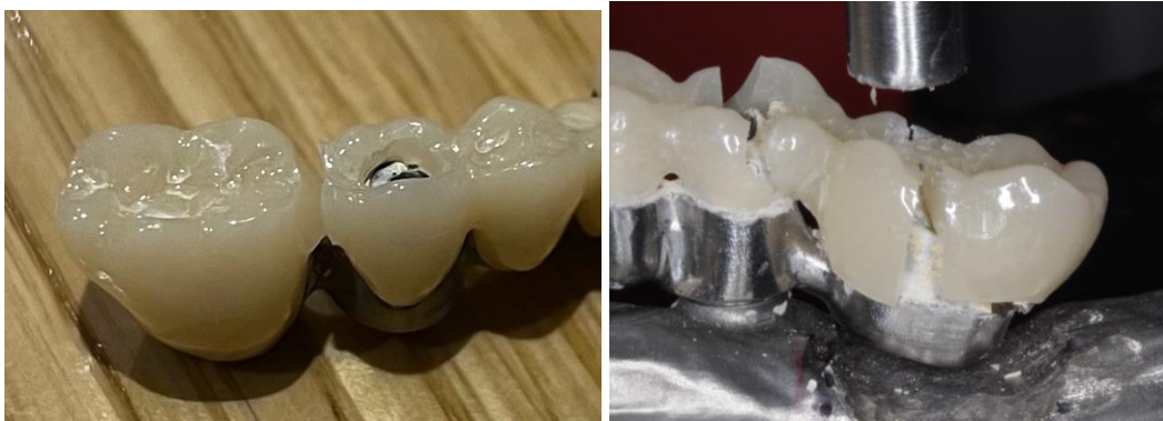
Figura 66. Fracturas grupo TI-HIPC: fractura de tipo cohesivo de la supraestructura de HIPC (izq.), fractura de tipo mixto junto con la deformación plástica de la estructura de titanio (derecha)
