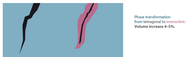
Figura 4: Fenómeno de transformación resistente
