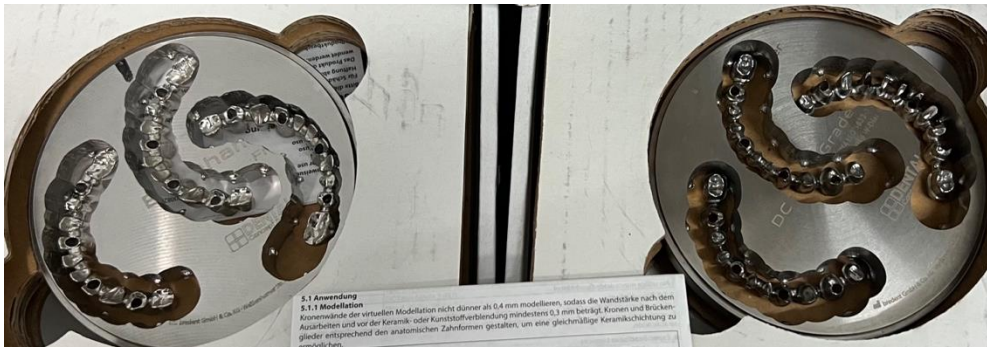
Figura 30. Estructuras de Cromo-Cobalto (a la izquierda) y de Titanio (a la derecha)
