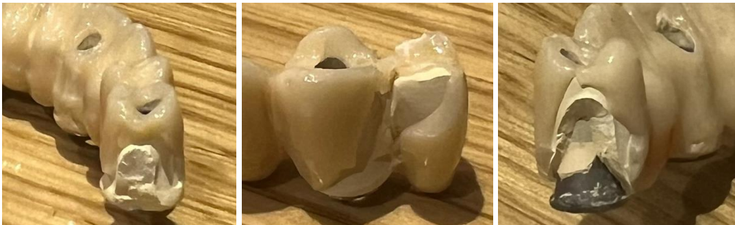
Figura 61. Fracturas grupo B-RC: fractura estructura a nivel del conector (izquierda), fractura recubrimiento adhesiva (medio), fractura estructura a nivel de la interfase (derecha).
