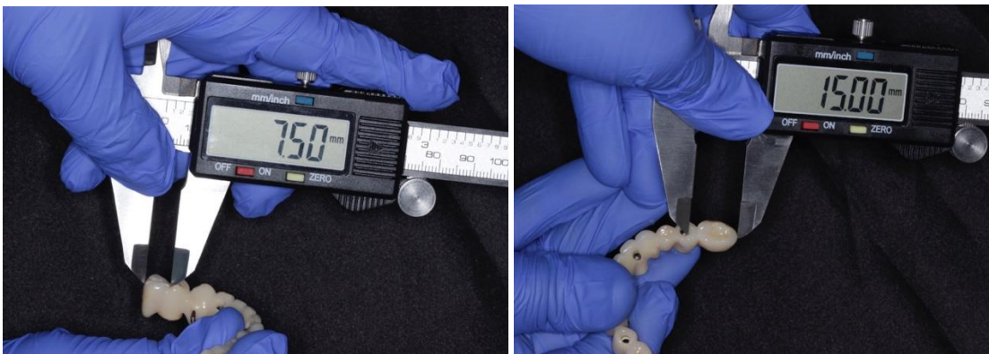
Figura 43. Comprobación longitud CL grupo Circonio-Cerámica (recubrimiento manual)
