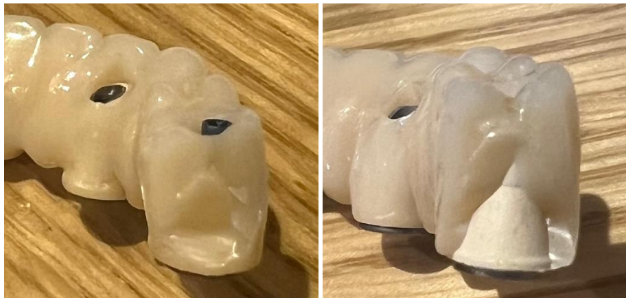
Figura 63. Fracturas grupo ZF-C: fractura estructura a nivel del conector (izquierda), fractura estructura a nivel de la interfase (derecha).
