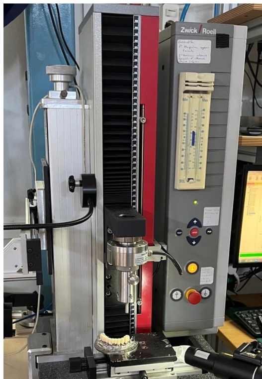
Figura 53. Máquina de ensayo universal Zwick Roell para el ensayo de flexión.
