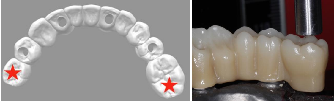
Figura 55. Puntos de aplicación de la carga en los cantilévers para el ensayo de flexión.
