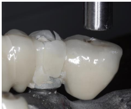
Figura 65. Fracturas grupo CRCO: fallo adhesivo extenso de la cerámica
