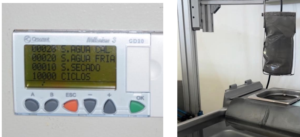
Figura 50. Configuración de parámetros de ensayo y máquina de termociclado
