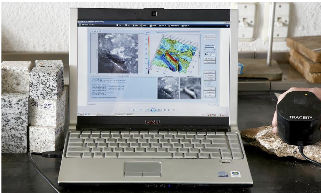
Figura 4.13. Rugosímetro óptico de superficie (TRACEiT, Innowep GMBH). Este dispositivo se encuentra en el Laboratorio de Petrofísica del Instituto de Geociencias-IGEO (CSIC, UCM). Figura obtenida de la página web del laboratorio Equipamiento, Laboratorio Petrofísica (laboratoriopetrofisica.es) .
