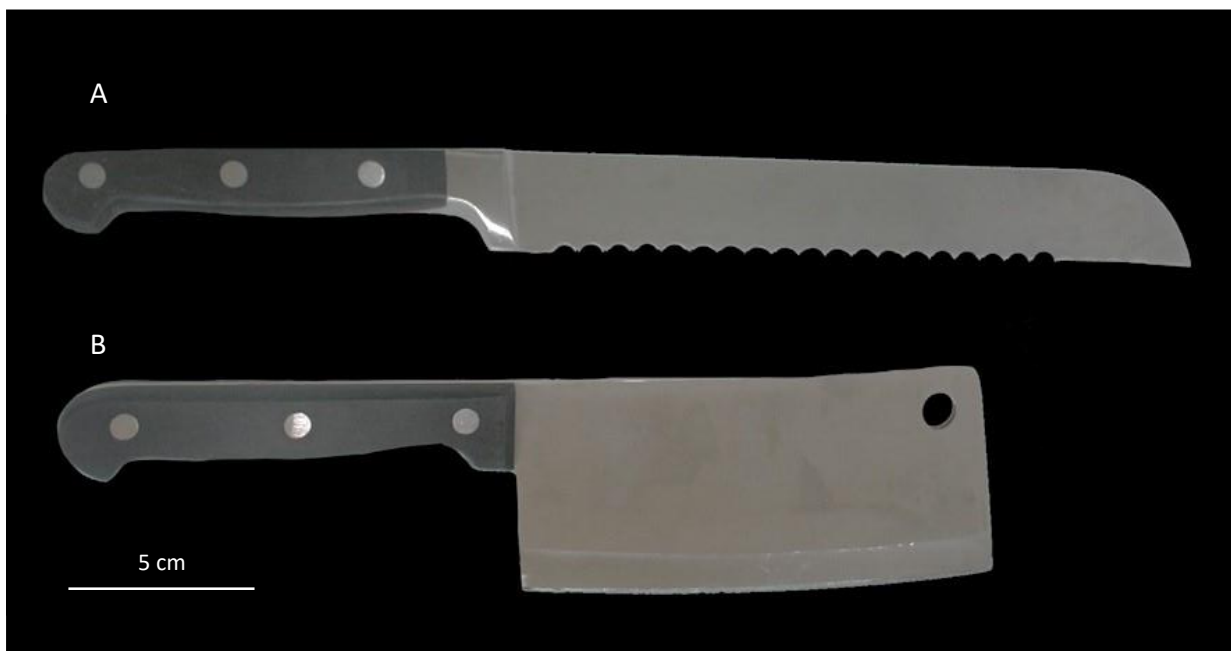
Figura 4.2. Cuchillo serrado de pan (A) y machete (B) utilizados para el estudio de marcas de corte en cadáveres cremados. Medidas del cuchillo de pan : longitud total: 370 mm, anchura máxima: 30 mm, distancia entre dientes: 9 mm, longitud de los dientes: 3 mm. Medidas del machete : largo: 300 mm, ancho: 45 mm, anchura de filo: 2 mm.
