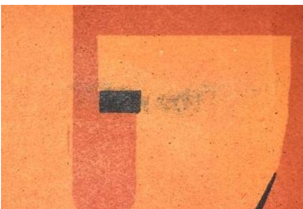
Figura 23. Error de impresión provocado por una extracción errónea de la plancha de color, situado en uno de los bordes del cartel. Se aprecian también numerosos y diminutos puntos del mismo color, originados por una aplicación descuidada de la tinta sobre la piedra. Fuente propia.
