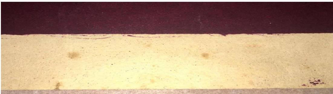
Figura 23. Error de impresión provocado por una extracción errónea de la plancha de color, situado en uno de los bordes del cartel. Se aprecian también numerosos y diminutos puntos del mismo color, originados por una aplicación descuidada de la tinta sobre la piedra. Fuente propia.
