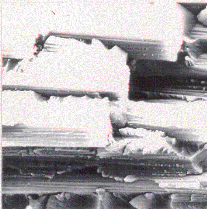
Figura 49: Superficie de fractura del MATERIAL 1 acondicionado durante 90 días a 70°C/100% H.R.
