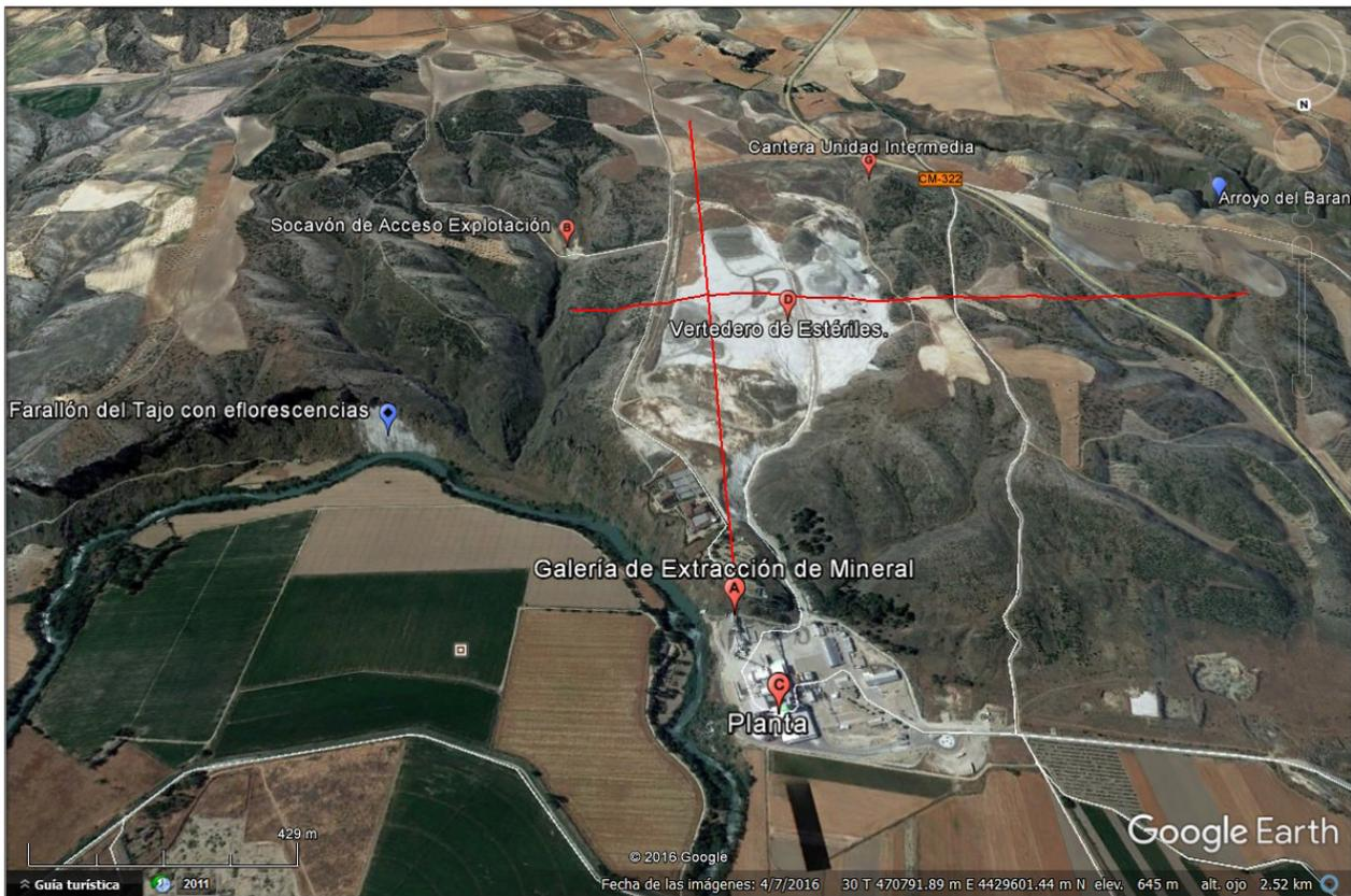
Figura 1. Vista de la planta de Minera Santa Marta, en primer término, contigua al Río Tajo. Las líneas dan una idea de la galería de extracción y labores mineras. Se señala el encajado arroyo del Barantolín, que preserva los minerales salinos de la disolución por las aguas subterráneas.
