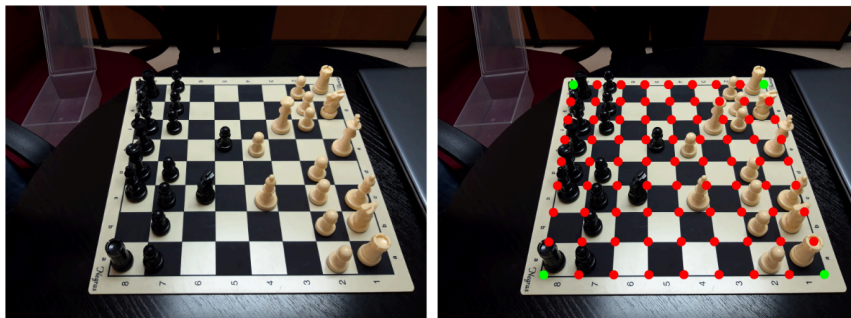
Figura 3-1. Ejemplo de una foto tomada de un tablero de ajedrez y la identificación de cada vértice.
