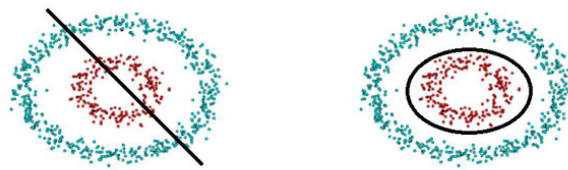
Figura 3.4: Fronteras de decisión con función de activación lineal y no lineal. Fuente: link
