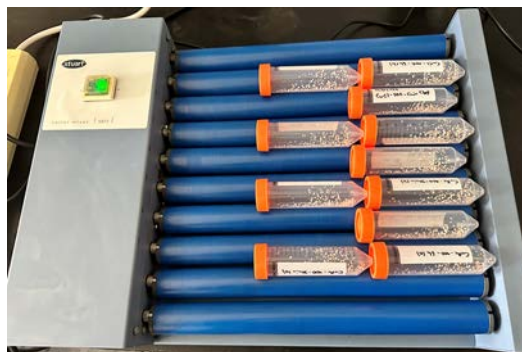
Figura 3.1. Imagen de los experimentos de interacción en el agitador de rodillos.
