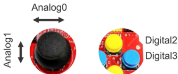
Figura 3.1: Asignación de los elementos físicos de input de una placa de Arduino UNO para que puedan ser interpretados por S4A
