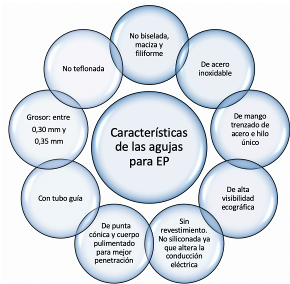
Figura 4. Características que deberían incluir las agujas utilizadas en la electrólisis percutánea.
