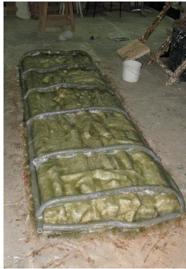
Proceso de moldes, contra molde y positivado en cemento
