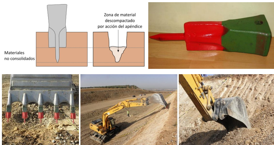
Figura 6.4. En la parte superior, un croquis del efecto esperado del producto y proceso objeto de patente. Arriba a la derecha uno de los prototipos construidos. Abajo a la izquierda, los prototipos montados sobre el cazo de una retroexcavadora (modelo góndola). Abajo en el centro, vista de la máquina trabajando para dar el acabado final a un desmonte sobre lutitas. Abajo a la derecha, efecto sobre el talud (M-224, Torres de la Alameda, Madrid)
