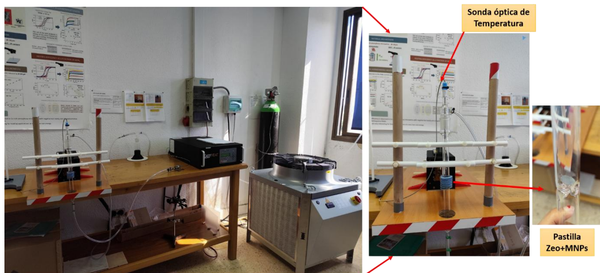
Figura 22. Configuración del reactor para el proceso de hidrocraqueo
