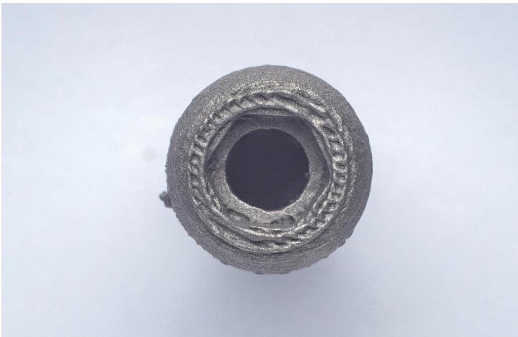
**Figura 13.** Pilar de cromo-cobalto con hexágono antirrotacional externo.
