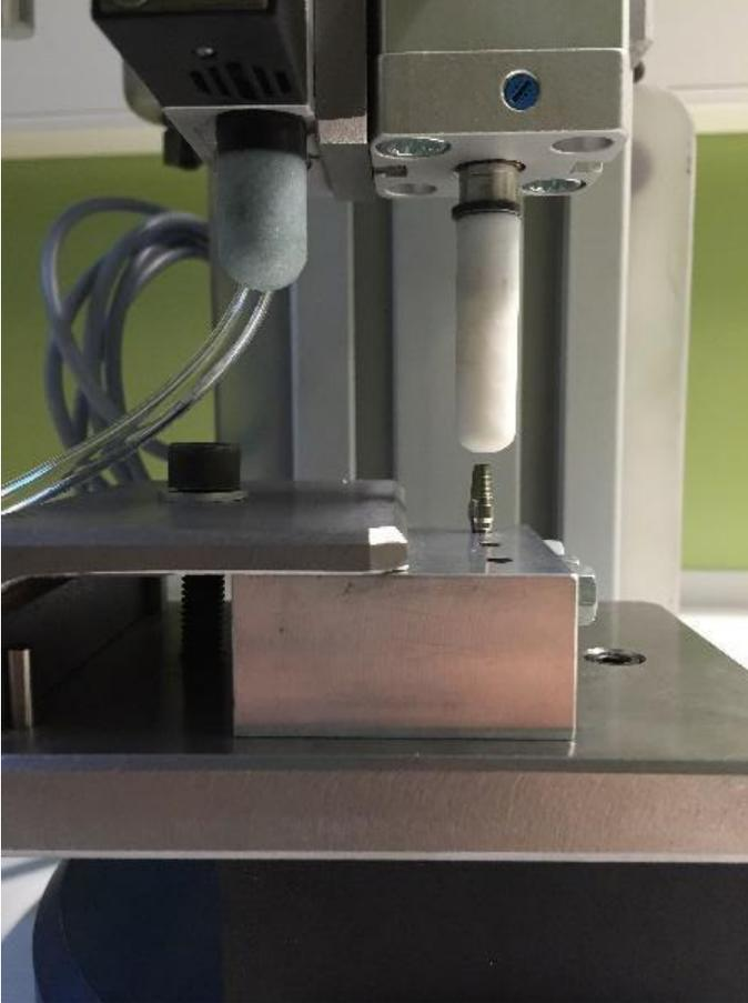
**Figura 23.** Muestra fijada a máquina de fatiga.
