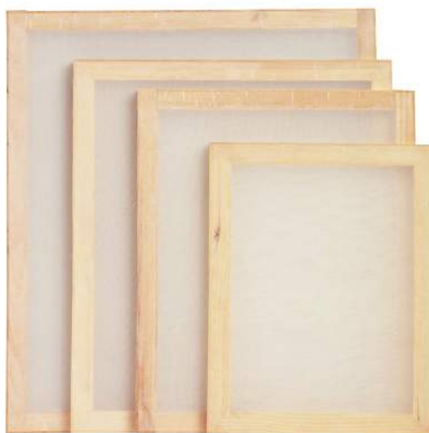
Fig. 173. Seda forrada en bastidores.
