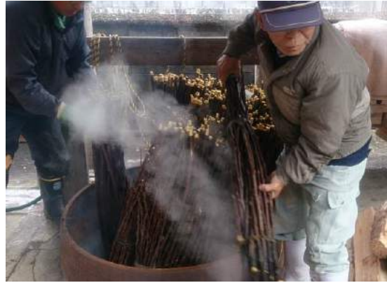
b. Vaporización de la madera.
