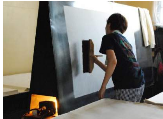
r. Adhesión del papel a la secadora.
