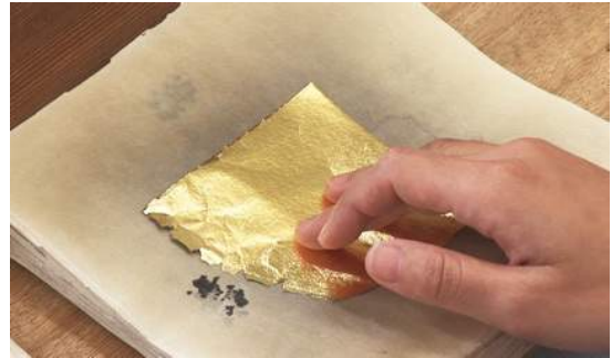
j. Obtención del tamaño koju (9 cm 2 ).
