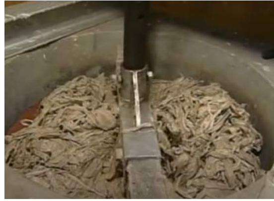
h. Estiramiento de las fibras.
