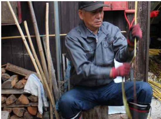
c. Retirada de la corteza.
