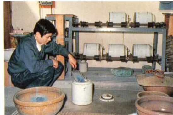
d. Colocación en el molino de bolas.
