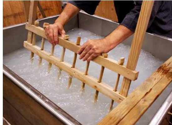
l. Mezcla de las fibras y el aglutinante.
