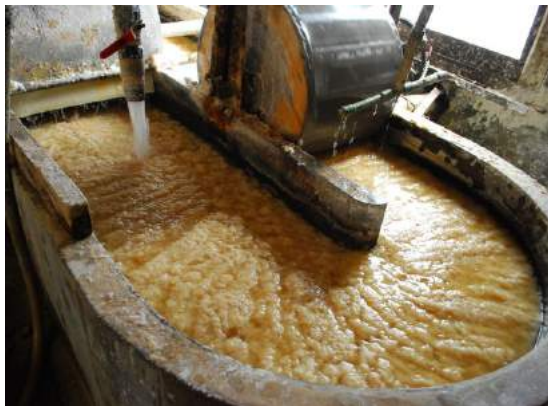
i. Refinamiento de las fibras.
