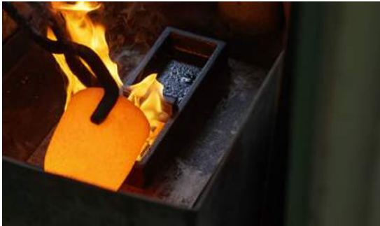
a. Vertido de la aleación al molde.
