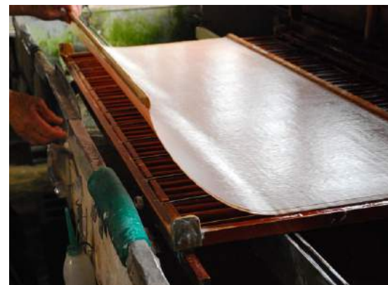
n. Posicionamiento de la capa.
