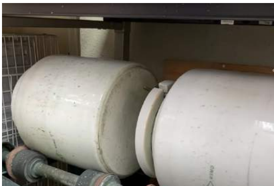
c. Molienda en molino de bolas.
