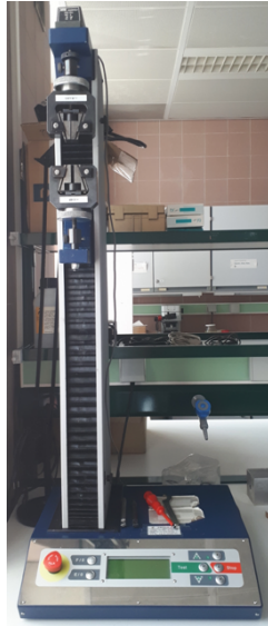
Figura 6. Máquina universal de ensayos. Laboratorio de Odontología Conservadora, Facultad de Odontología, Universidad Complutense de Madrid.
