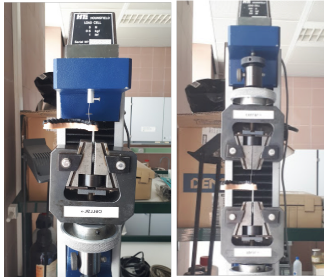
Figura 8. Célula de carga de 5 N (imagen izquierda). Célula de carga de 500 N (imagen derecha).
