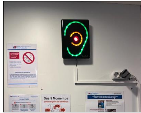
Figura 17. Sensor-indicador de ruido SoundEar II®
