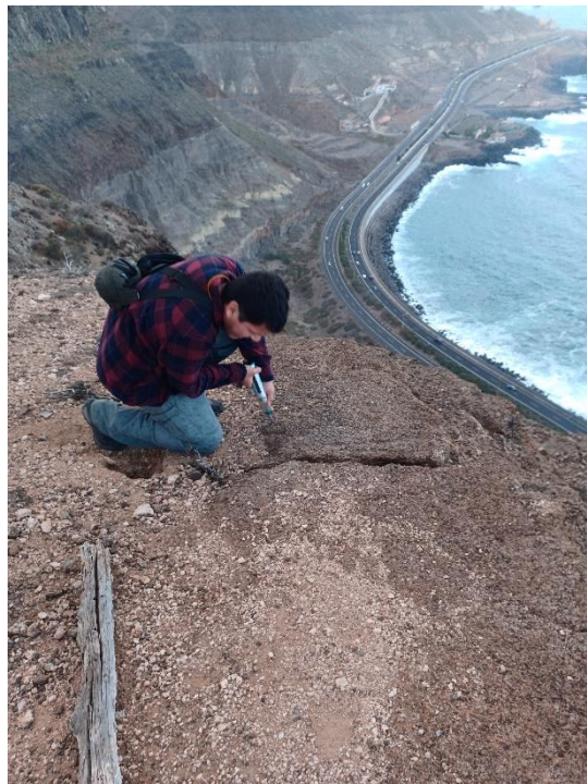
Figura 19: Ensayo de esclerometría con martillo Schmidt. Ensayo realizado sobre los piroclastos de caída, en la coronación del acantilado El Rincón. Marzo 2024.
