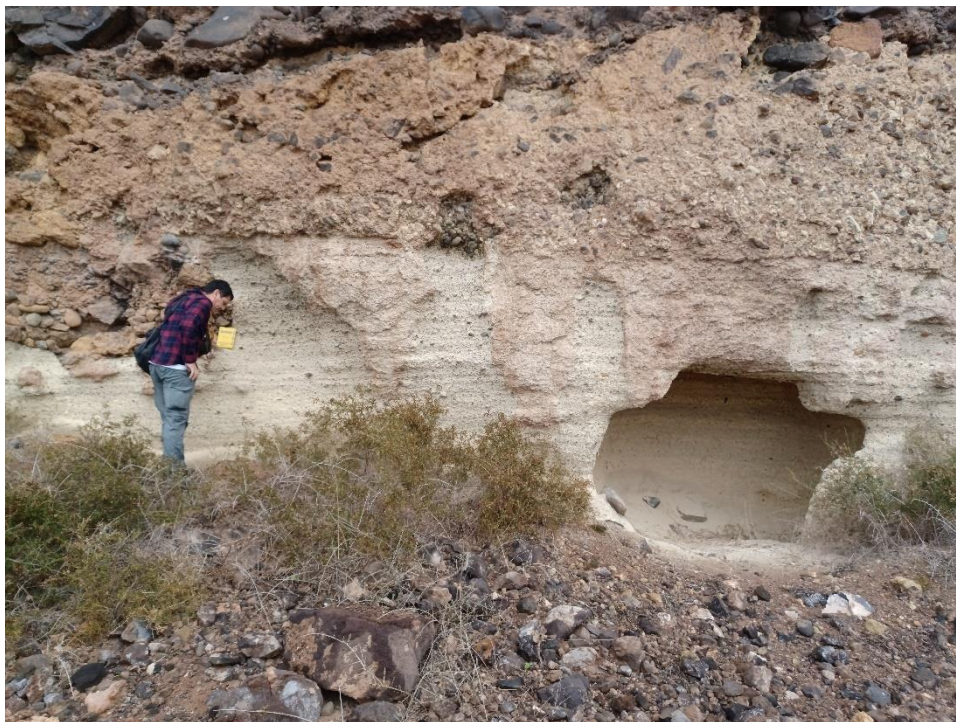
Figura 09: Afloramiento donde se distingue con claridad el contacto entre las ignimbritas no soldadas (IGNS) en la base y las ignimbritas soldadas (IGN) por encima. Este detalle resulta clave para entender la superposición de materiales en el talud, así como para reconocer el contraste en sus propiedades mecánicas.
