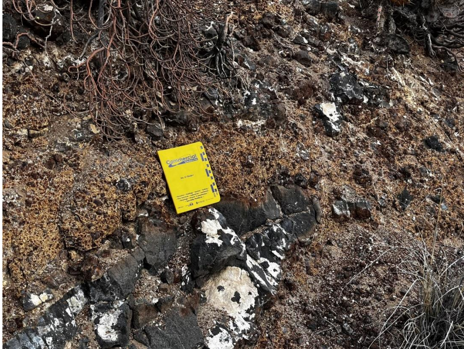
Figura 13: Afloramiento que muestra las lavas basálticas escoriáceas del Grupo Roque Nublo, con presencia de pillow lavas. Este afloramiento evidencia condiciones de enfriamiento rápido en ambiente subacuático o con humedad alta, lo que influye directamente en la fracturación del material y, por tanto, en su comportamiento geotécnico.
