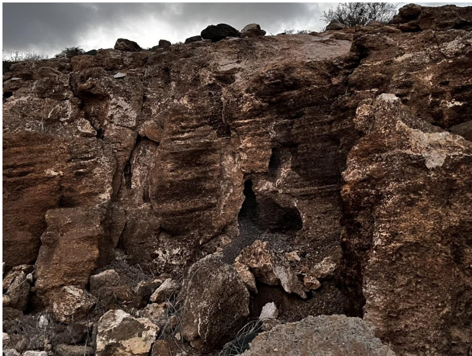
Figura 14: Afloramiento representativo de los depósitos de tefra y piroclastos del Ciclo Post Roque Nublo. Se observa un grado alto de meteorización (GM IV – V – VI), lo que justifica su clasificación como suelo residual en el modelo geotécnico. Este material presenta baja resistencia, y alta porosidad, siendo estas particularidades las que lo caracterizan.
