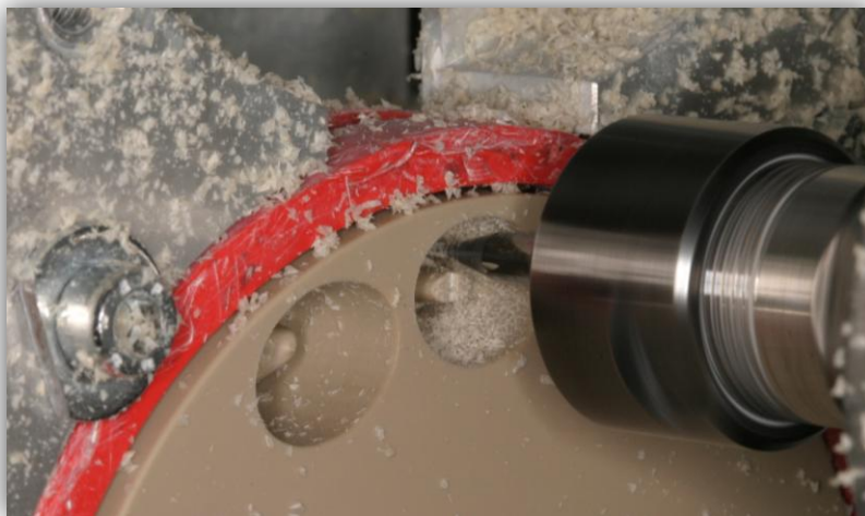
Figura 37: Fresado del disco de PEEK.
