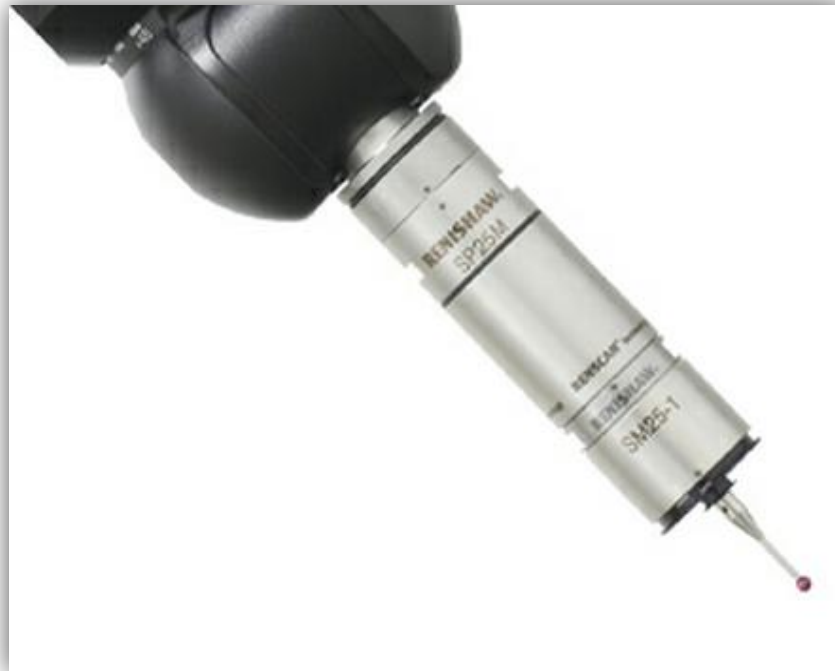
Figura 41: Cabezal y punta palpadora de la CMM.
