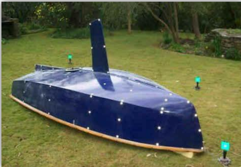
Figura 10: Utilización de la fotogrametría para la medición de un objeto.
