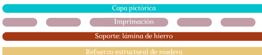
FIG.28: Esquema del corte estratigráfico de Noland mirage .
