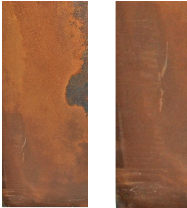
FIG. 1 y 2 DEL ANEXO III.- Detalle de las abrasiones. Fuente propia.
