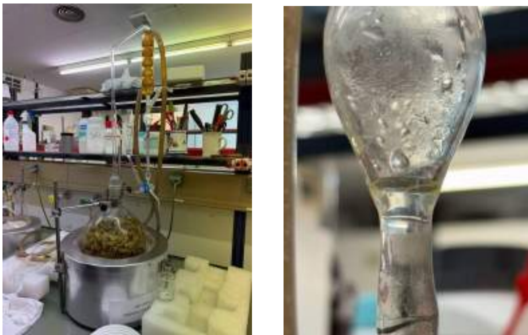
Figura 4. Extracción de los aceites esenciales y detalle del aceite obtenido.
