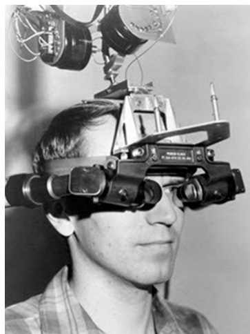
Figura 2.4: Aspecto del visor para Sword of Damocles . Fuente: Sutherland
