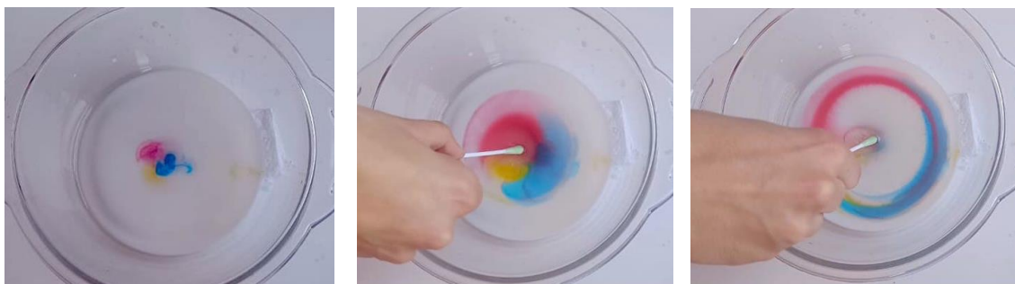
Figura 5. Secuencia de fotos de la experiencia huida, en la que se observa la diáspora de colores debido a la disminución de tensión superficial.
