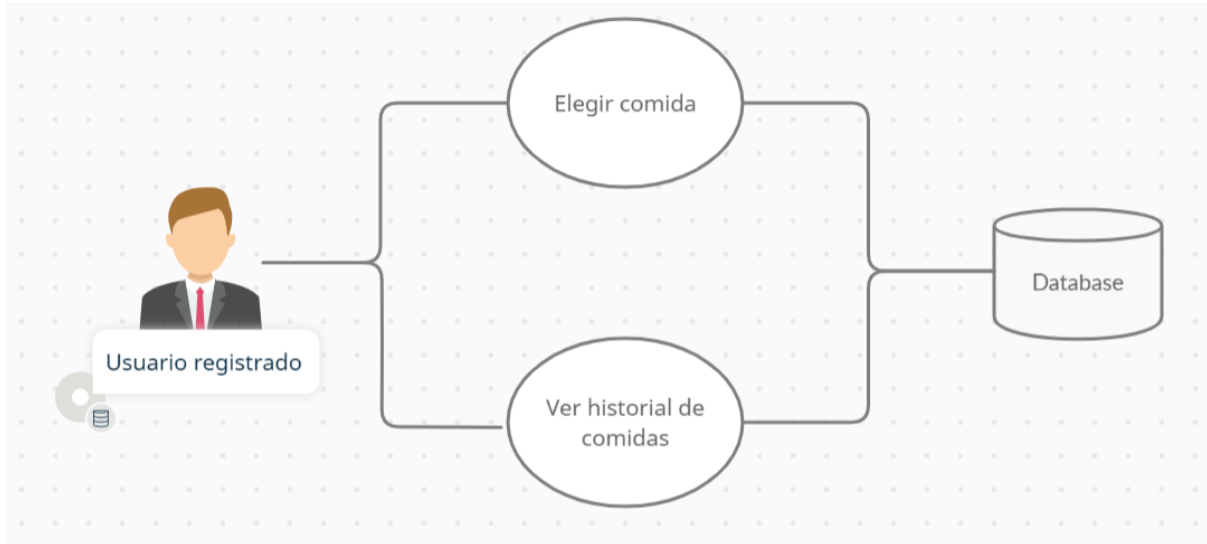
Figura 4.5: Diagrama de casos de uso del módulo gestionar comidas
