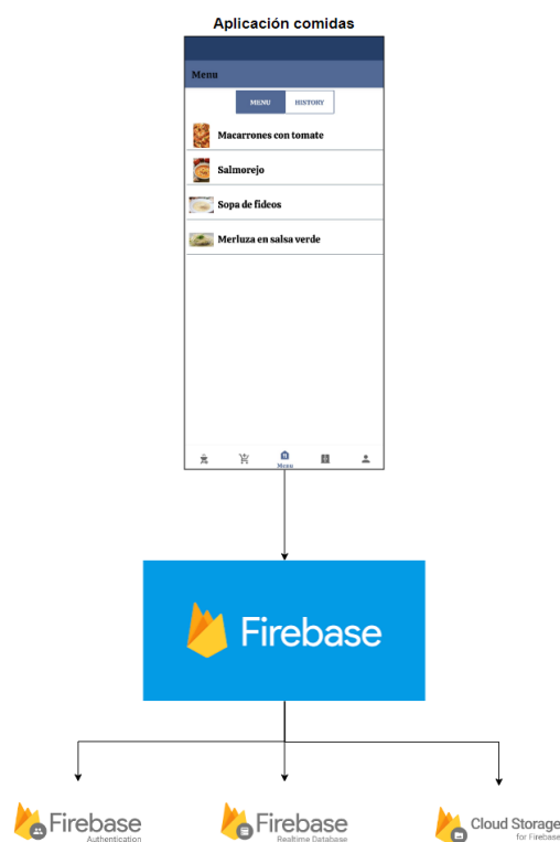
Figura 5.1: Esquema arquitectura de la aplicación
