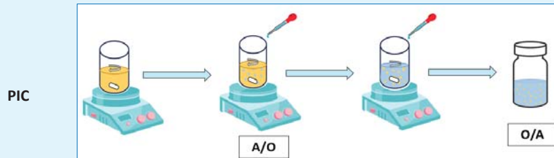
Figura 4. Esquema del método de inversión de fase por composición.
