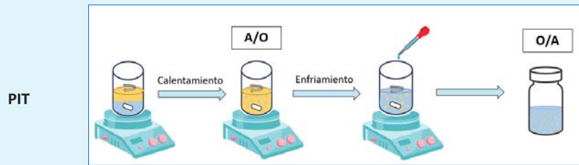
Figura 3. Esquema del método de inversión de fase por temperatura.
