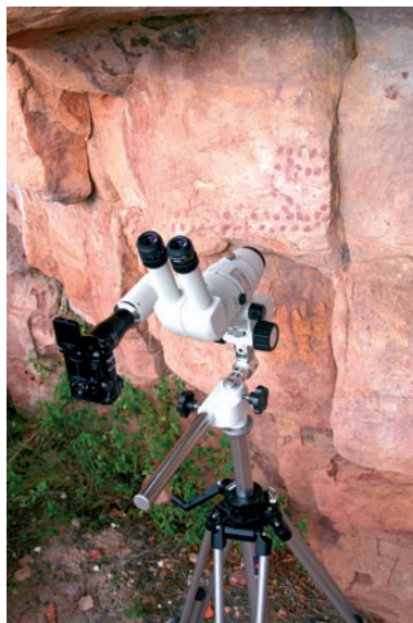
Microscopio estereoscópico Nikon utilizado en los trabajos de análisis traceológicos, en este caso en Marmalo III (Villar del Humo).
