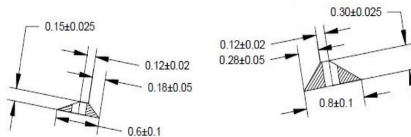
Figura 17. Sección que muestra la diferencia de espesor y base en los extremos del ICRL asimétrico AJL-PRO+ 244
