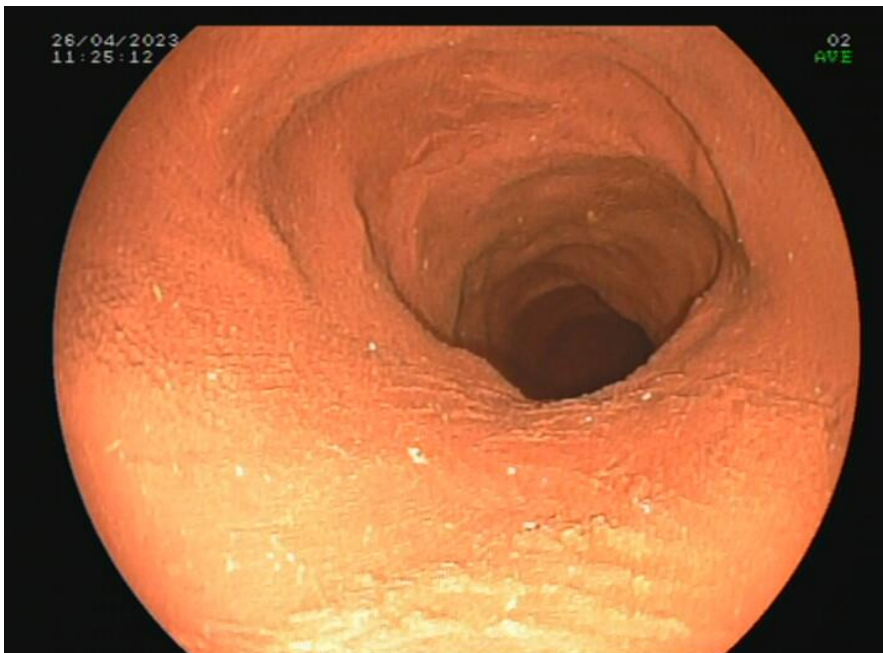
Figura 8. Imagen tomada con el fibroendoscopio a su paso por el colon descendente del modelo 3D impreso en látex.
