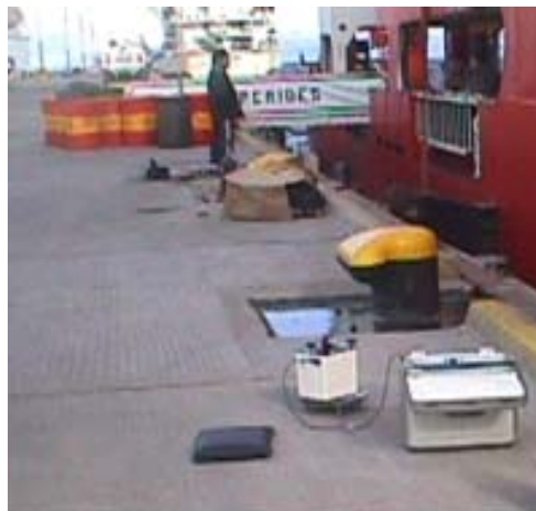
Figura 6: Gravímetro terrestre Lacoste & Romberg. Enlace con las redes terrestres en el muelle Carenero de Cartagena
