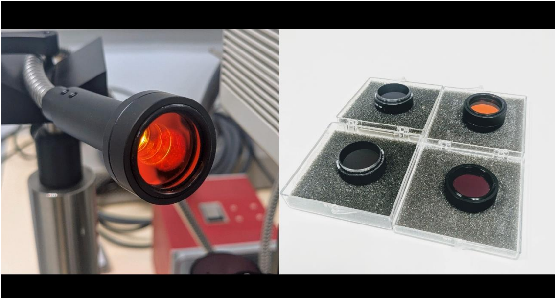
Figura 12: fotografía de los filtros empleados para la captura las imágenes con el meibógrafo de luz visible (VisMeib)
