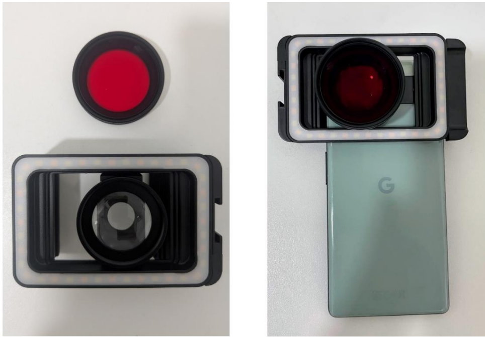
Figura 17: sistema experimental para la captura de las meibografías
