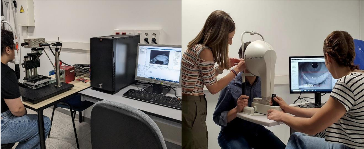
Figura 13: imagen de los dos dispositivos estudiados. A la derecha se muestra el K5M y en la izquierda el VisMeib.
