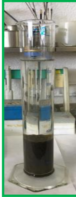
Figura 4.1: Fotografía del resultado de la decantabilidad (V30) de una de las muestras tomadas en la cámara aeróbica.
