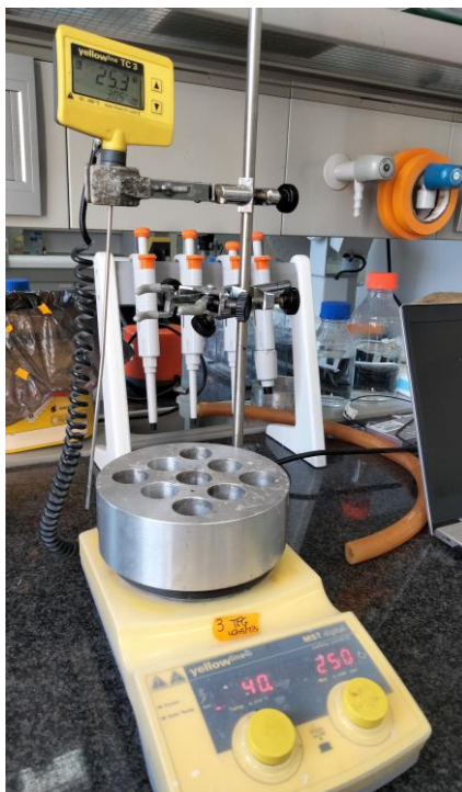
Figura 3.3. Sistema experimental de medición de actividad enzimática. Consta de una placa calefactora con termopar y agitación, junto con viales de vidrio de 7 mL de volumen total.
