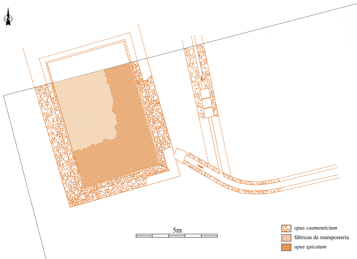
FIG. 9. Reconstrucción planimétrica de la primera fase constructiva –piscina del frigidarium– (Morillo, Durán y Martín Hernández).
