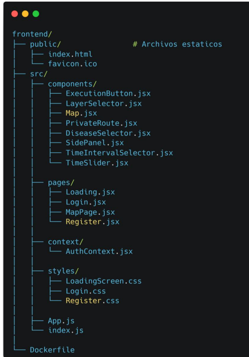
Figura 4-4: Representación gráfica de la estructura del "front-end"
