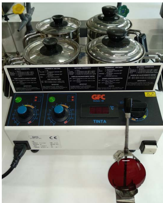
Figura 1. Equipo de coloración de lentes oftálmicas de CR-39 y lente coloreada en la pinza de sujeción.
